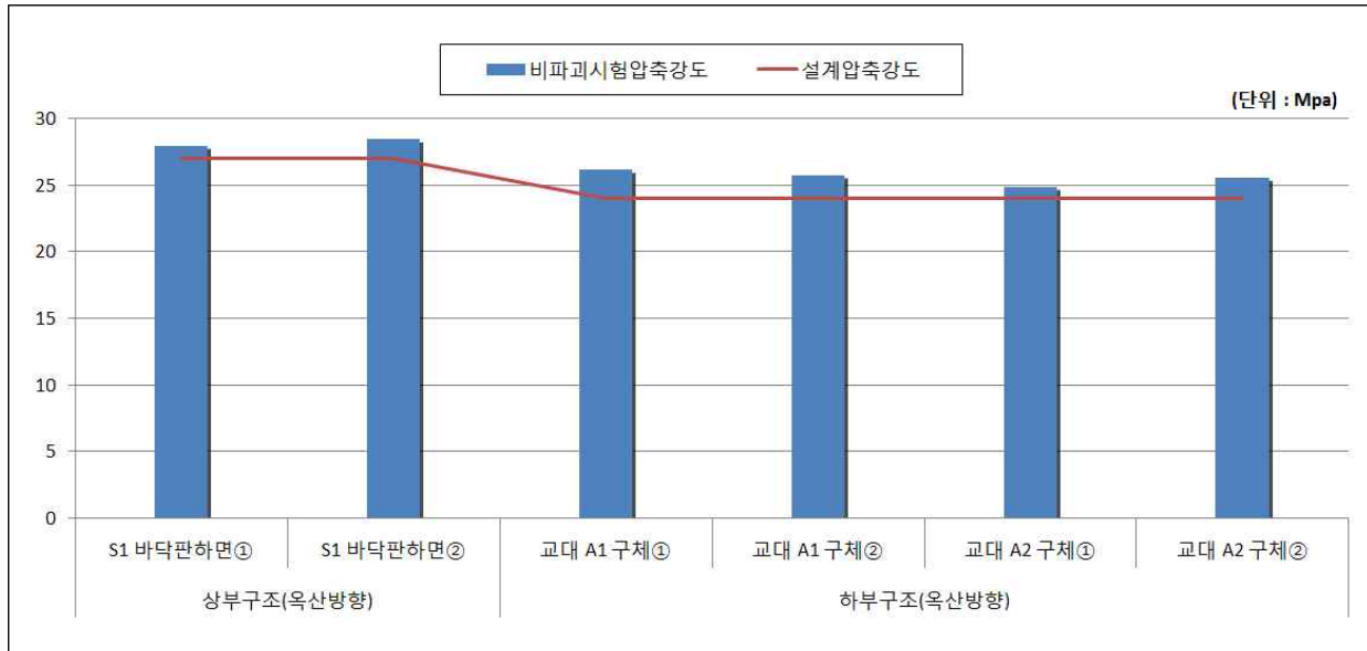
【그림 2.6.6】 콘크리트 강도시험 결과 그래프
